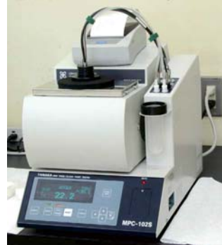
自動流動点・曇り点試験器
