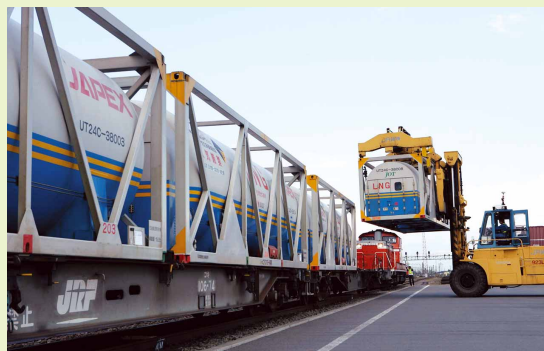
LNGタンクコンテナ鉄道輸送 (タンクコンテナを貨車に積載)
