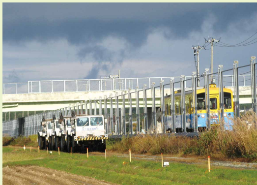
パイプロサイス（物理探鉱用車両）による物理探鉱作業（秋田県）
