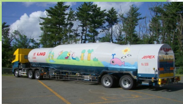
LNGローリー
