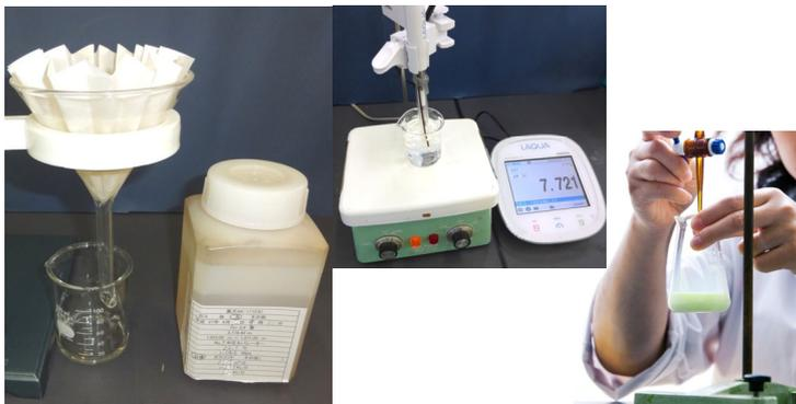
試料は分析項目に応じて前処理をして、湿式分析や機器分析を行います。機器分析が難しい現場や、すぐに分析結果を把握したい時などには、試薬の色や、色が変化するまでに滴下した試薬の量を用いて、成分の定性分析や定量分析を行います。
