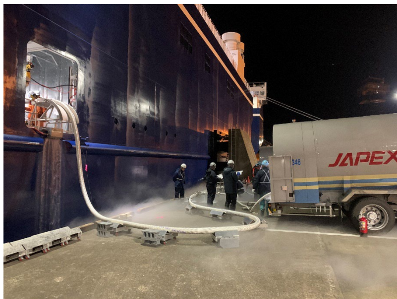
タンクローリー4台とスキッドによる LNG 燃料供給
