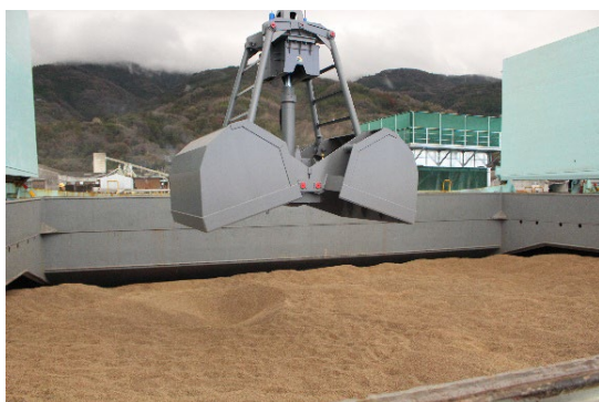
木質ペレットを船から荷揚げする様子
