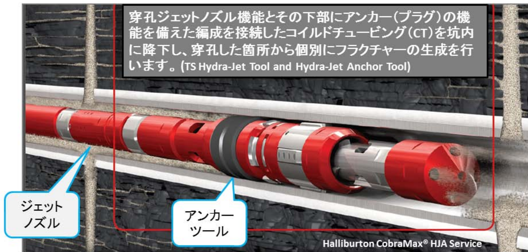
図2 コイルドチュービング(CT)を使用したフラクチャリング
