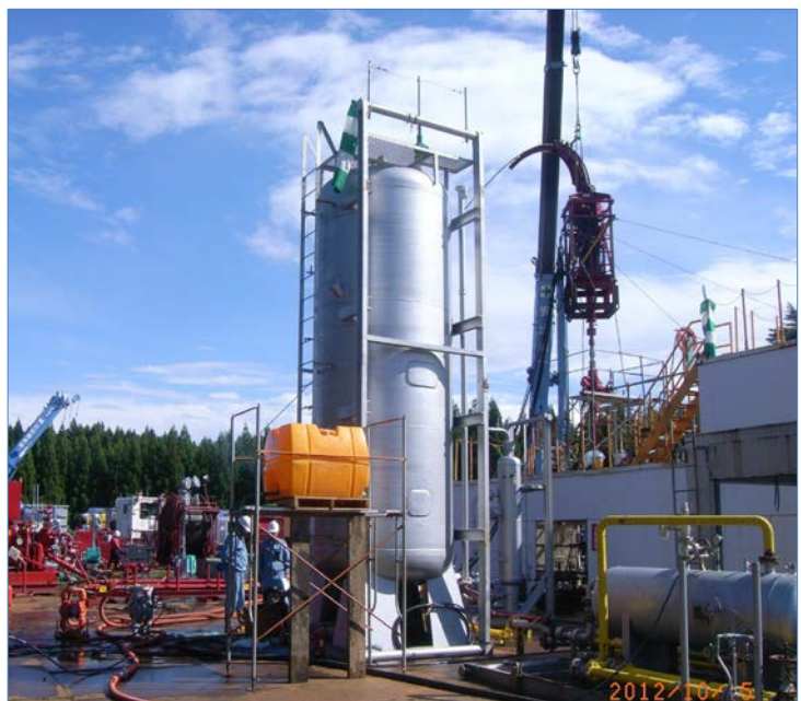
鮎川油ガス田（秋田県）における酸処理テストの様子
