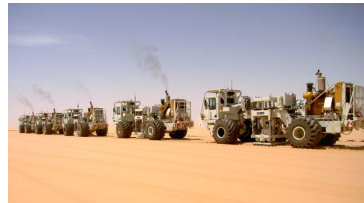
地震探鉦作業車（176-4鉦区）
