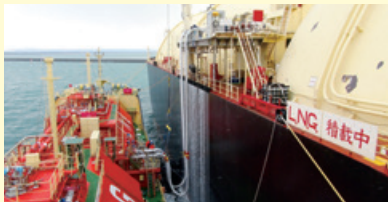
2011～2012年に実施した苫小牧港でのLNG船舶間輸送
